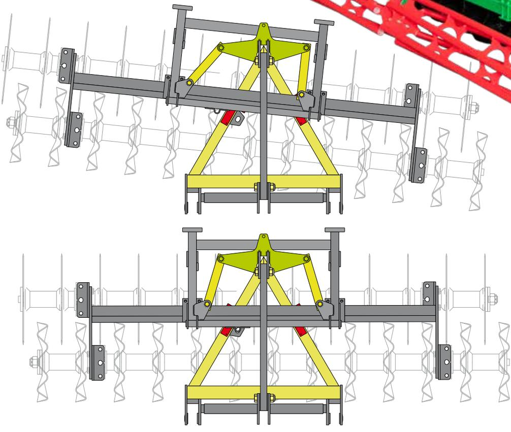
Durch die Trapezführung werden die Walzen automatisch in Fahrtrichtung gelenkt.
