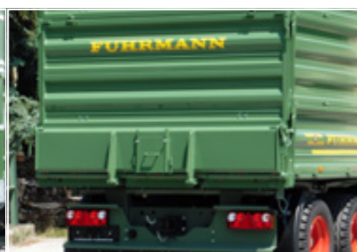
Hydraulische Heckklappe doppelw. 400 mm hoch (geschlossen)
