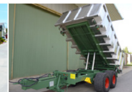
Tandem Rückwärtskipper 15 to - 25 km/h 4140 x 2480 x 1000 mm Nirosta Wanne
