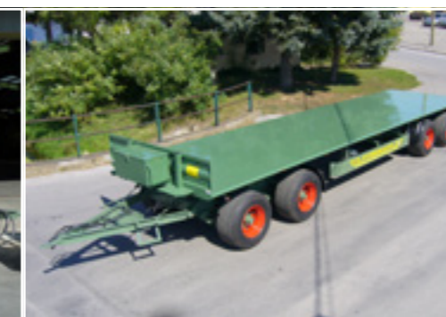
4-Achs Plateauanhänger 32 to - 40 km/h 10000 x 2550 mm
