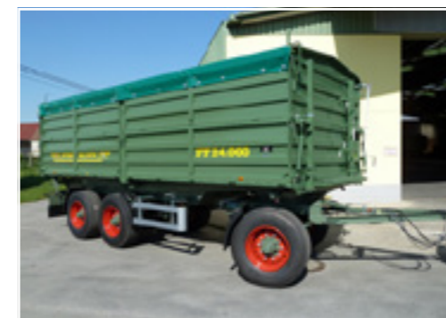
3-Achs-3-Seitenkipper 24 to - 40 km/h 7500 x 2480 x 1600 mm
