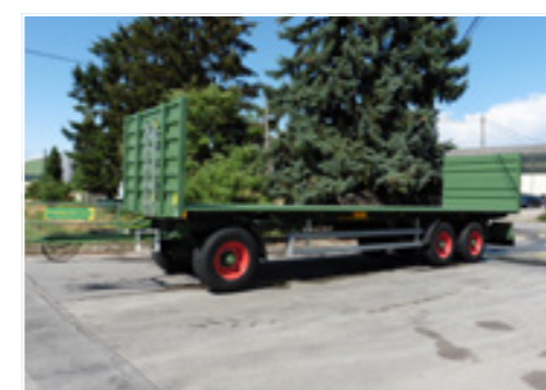
3-Achs Strohtransporter 24 to - 40 km/h mit ausziehbarem Plateau
