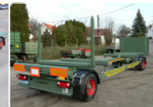
2-Achs Rungenwagen 13 to - 80 km/h mit ausziehbarem Fahrgestell
