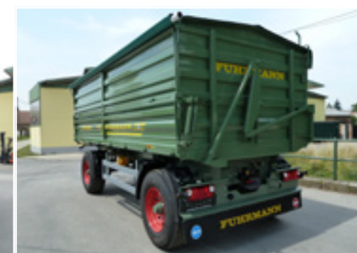
Automatische, mechanische Bordwandöffnung (90°) für 2-Seitenkipper
