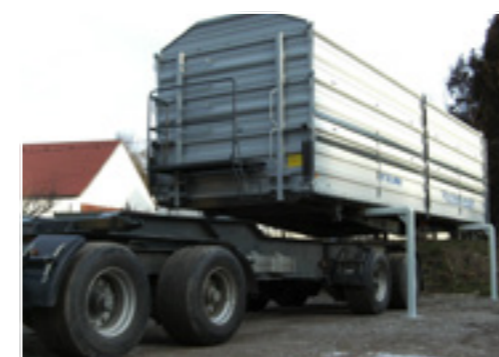
4-Achs-3-Seitenkipper / 32 to - 40 km/h 8500 x 2480 x 2000 mm mit konischer Brücke und Wechselaufbausystem
